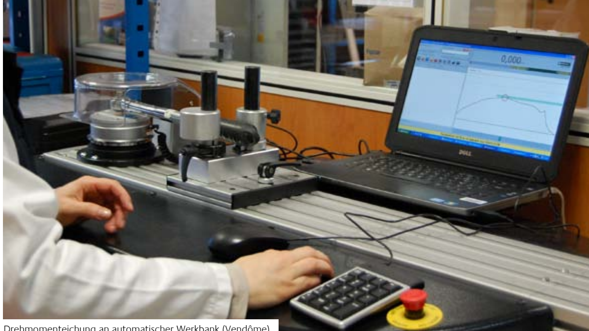
Drehmomenteichung an automatischer Werkbank (Vendôme)
