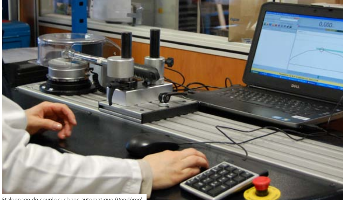
Étalonnage de couple sur banc automatique (Vendôme)
