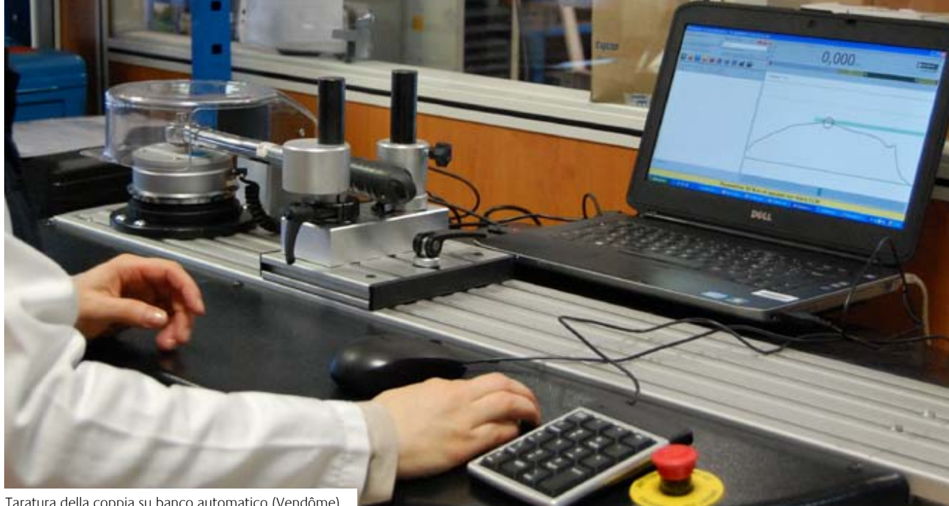
Taratura della coppia su banco automatico (Vendôme)
